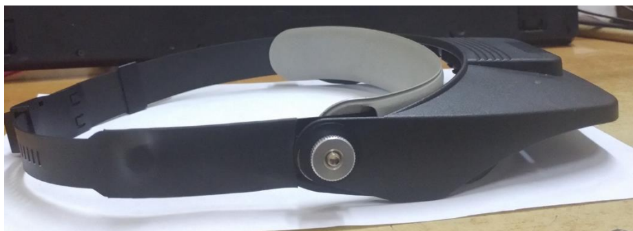
- Fig.4 Amplasarea elementului piezoelectric pe carcasa dispozitivului - (în partea dreaptă direct pe osul craniului)
