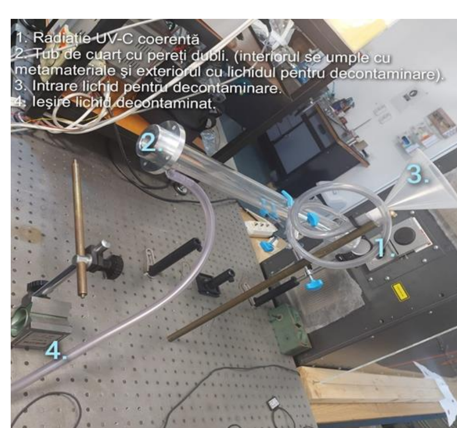
Figura 1. Echipament de decontaminare care poate funcționa atât în regim static cât și în tratament dinamic, alcătuit dintr-un cilindru de cuarț cu lungime de 70 cm, umplut cu metamateriale optice iradiate cu radiație coerentă UV-C. În cazul regimului de tratare dinamică, tubul este conectat cu un rezervor exterior prin care circulă lichidul contaminat (aproximativ 200 mL) pompat continuu de o pompa electrică.
