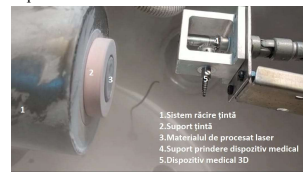
Figura 1. Procedeu de funcționalizare MAPLE a suprafețelor medicale. Pivotalul radicular anatomic din titan a fost înșurubat în suportul metalic care face posibilă rotirea și înclinarea prototipului de implant medical în timpul depunerii și acoperirea întregii suprafețe.
