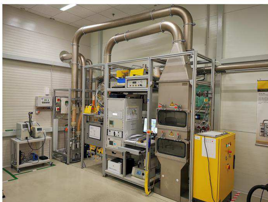
Stand de testare Topas PAF113 Utilizat in determinare căderii de presiune și cuantificarea capacității de retenere a elementelor fintrante
