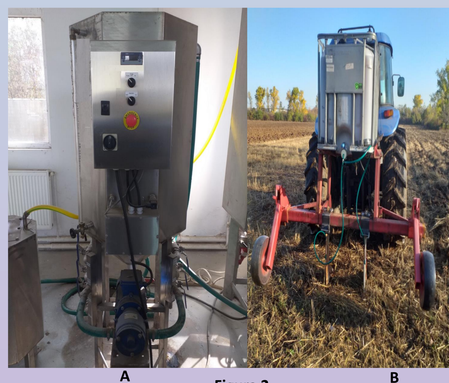
Figura 2 A - Exemplu de design de bioreactor; B - Aplicarea biofertilizanților utilizând echipamente agricole subsoliere
